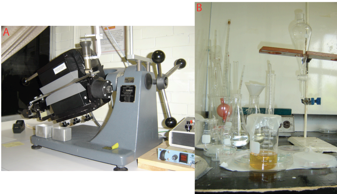
Foto 10. A. Separador magnético Frantz. B. Vaso de precipitado con politugstato de sodio y un embudo de separación.
