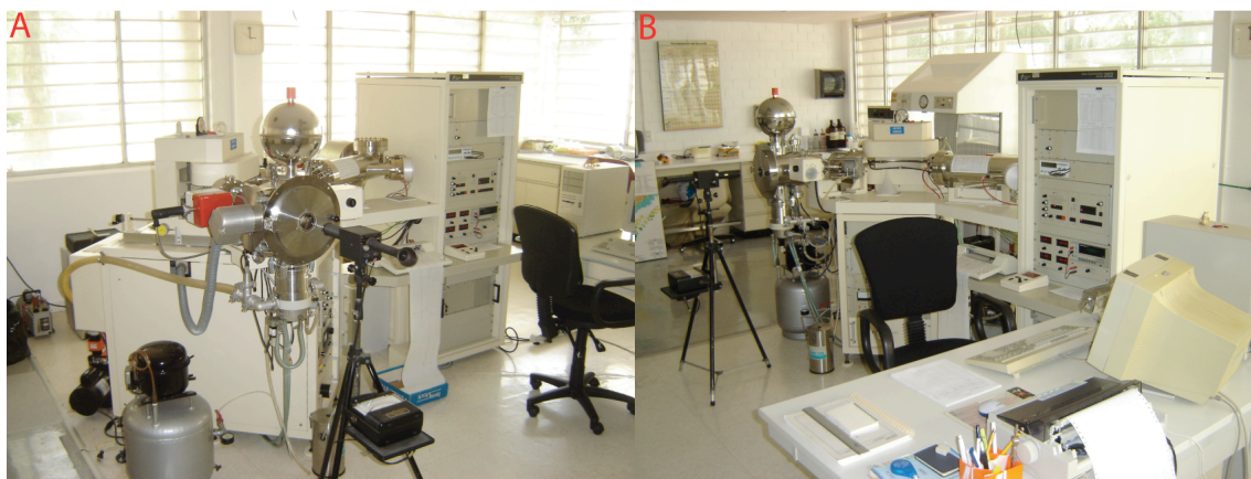
Foto 16. Espectrómetro de masas de ionización térmica Finnigan MAT-262. A. Se observa en primer plano la fuente donde se ionizan las muestras. B. Se observa el electroimán y los componentes electrónicos del aparato.
