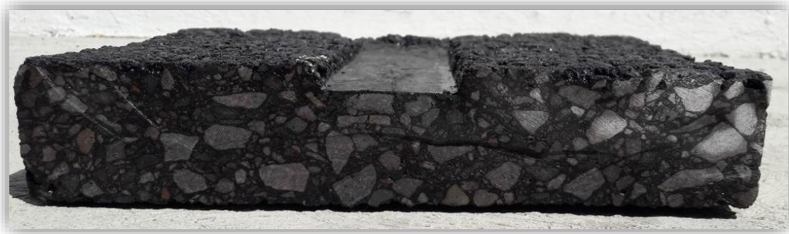
Figura 27. Rueda en espécimen después de la prueba
