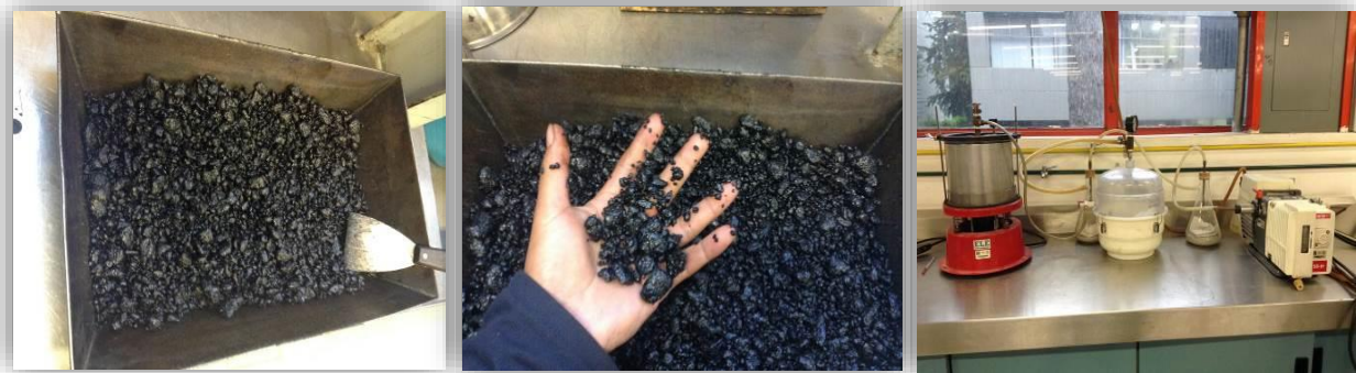
Figura 17. Procedimiento Densidad de RICE
