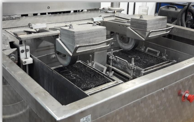
Figura 26. Losas ya colocadas en moldes, en acondicionamiento
