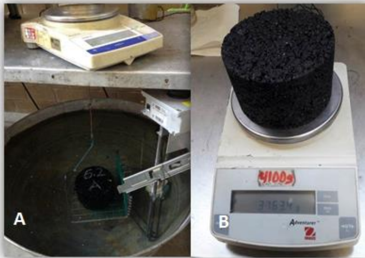
Figura 18. Determinación de Gmb de los especímenes
