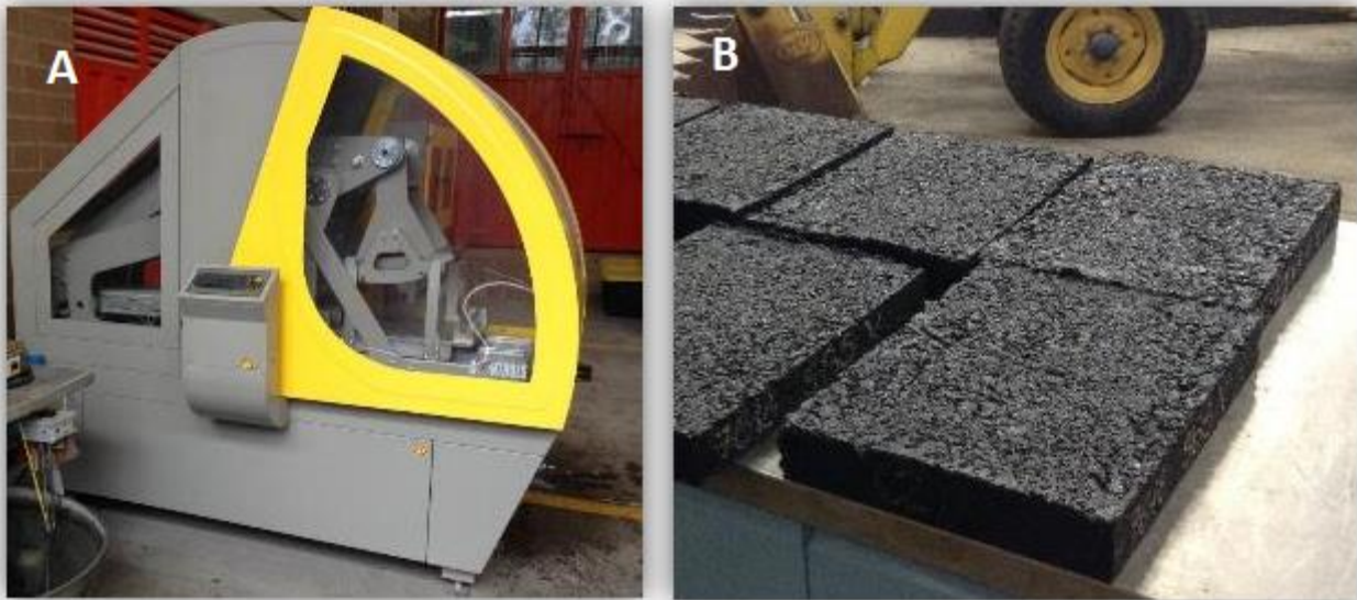
Figura 25. . Equipo compactador utilizado y placas
