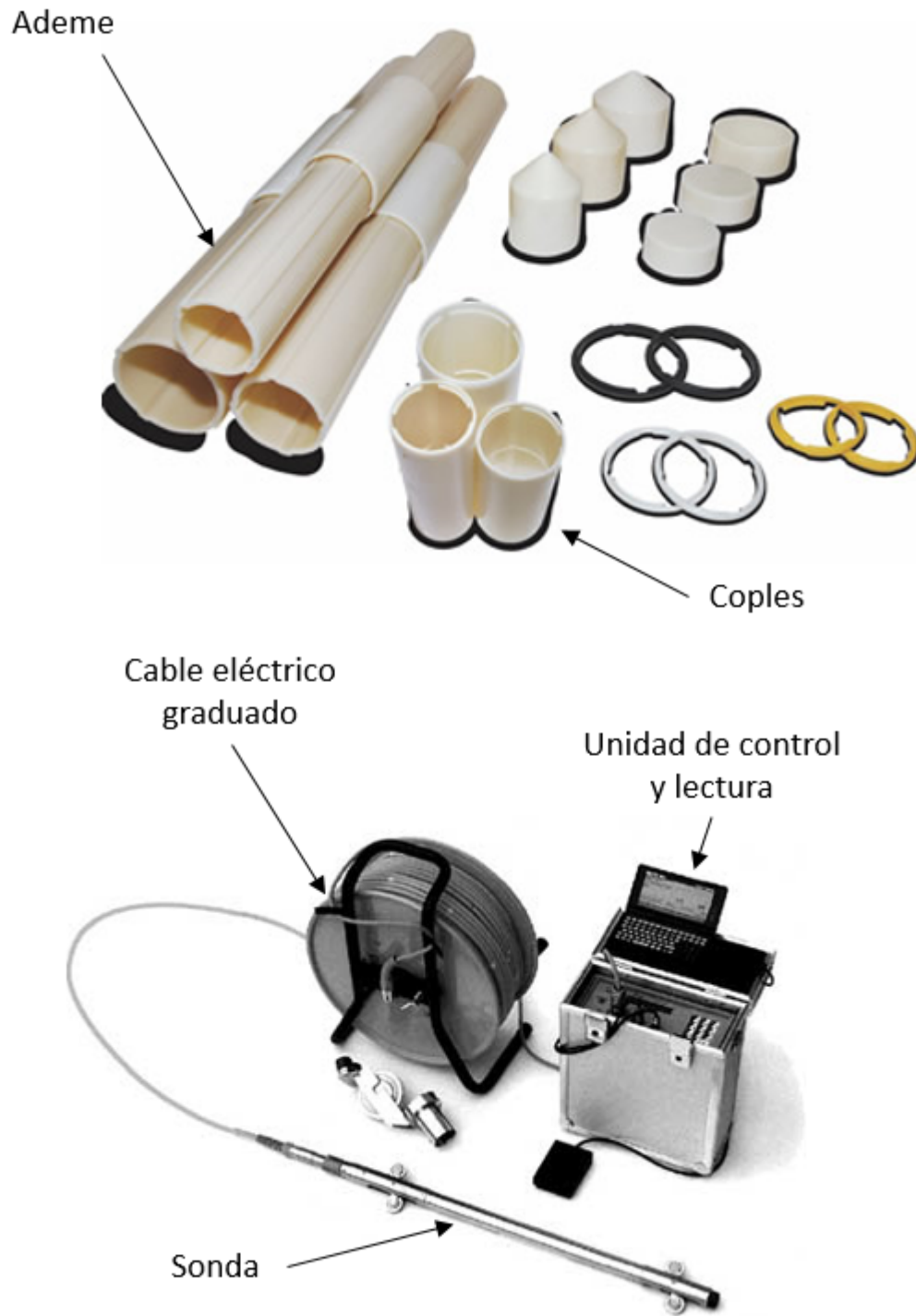
Figura 19. Elementos principales de un inclinómetro
