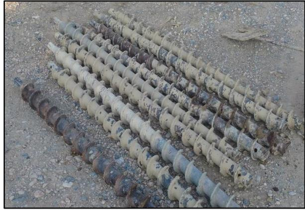
Barrenas Helicoidales utilizadas para avance.
