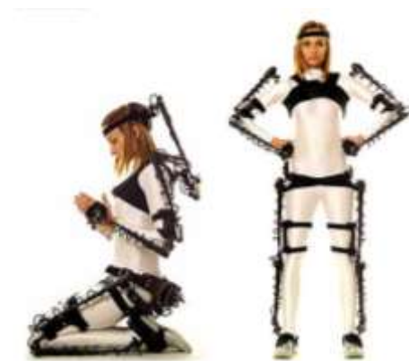
Figura 1. Traje electromecánico para seguimiento humano.
