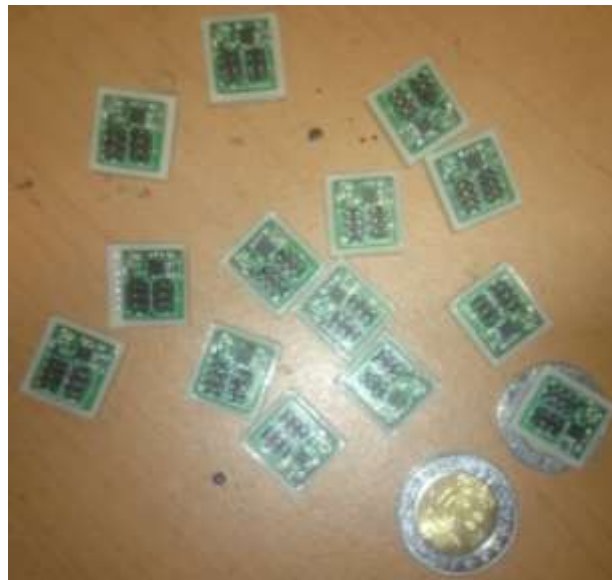
Figura 48. Tarjeta diseñada para el sensor MPU-9250 y una referencia de su tamaño.
