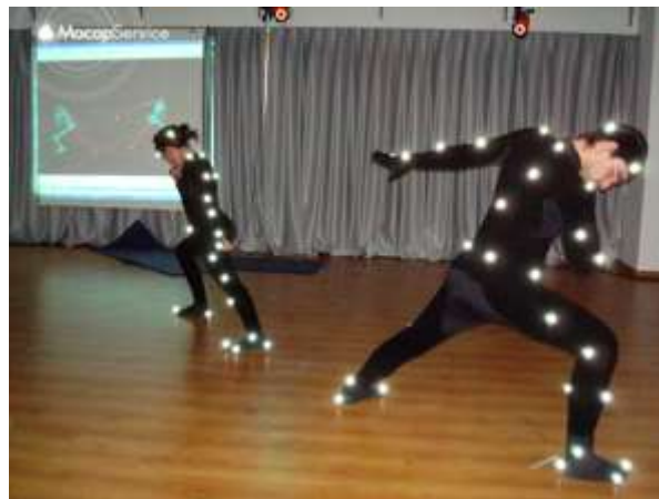
Figura 2. Sistema óptico de seguimiento humano utilizando indicadores.
