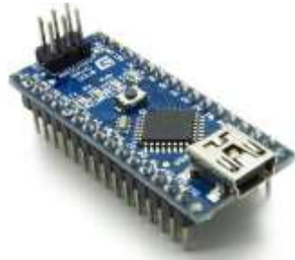
Figura 10. Microcontrolador ATmega 328 en tarjeta de desarrollo Arduino Nano.
