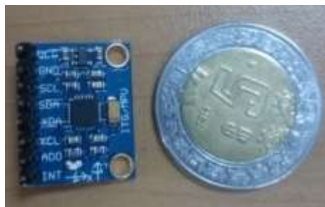
Figura 7. Tarjeta con sensor MPU-6050 de la marca Invensense y una referencia de su tamaño.
