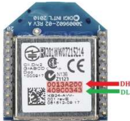
Figura 15. Número de dirección de destino de las antenas de radiofrecuencia Xbee.
