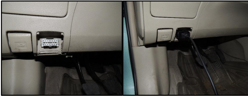
Ilustración 3.9. Conexión OBDII del vehículo de pruebas, Toyota Corolla 2009.
