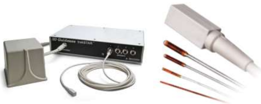
Figura 57.- Sistema de captura electromagnético de la empresa Ascension. Cada Trackstar puede medir 4 sensores de 6 DoF [78].
