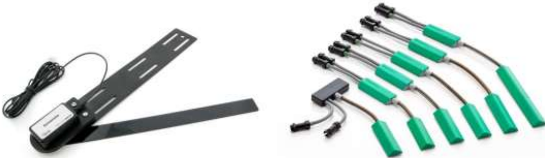
Figura 56.- Goniómetro de un plano de la empresa Vernier (izquierda) [79] y goniómetros de doble eje de la compañía Biometrics [80].
