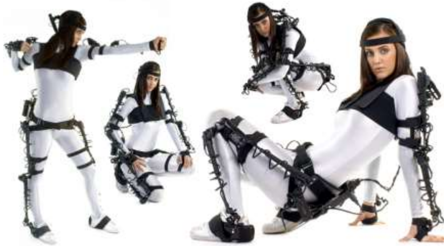
Figura 55.- Sistema electromecánico Gypsy 6 de la empresa MetaMotion [78].
