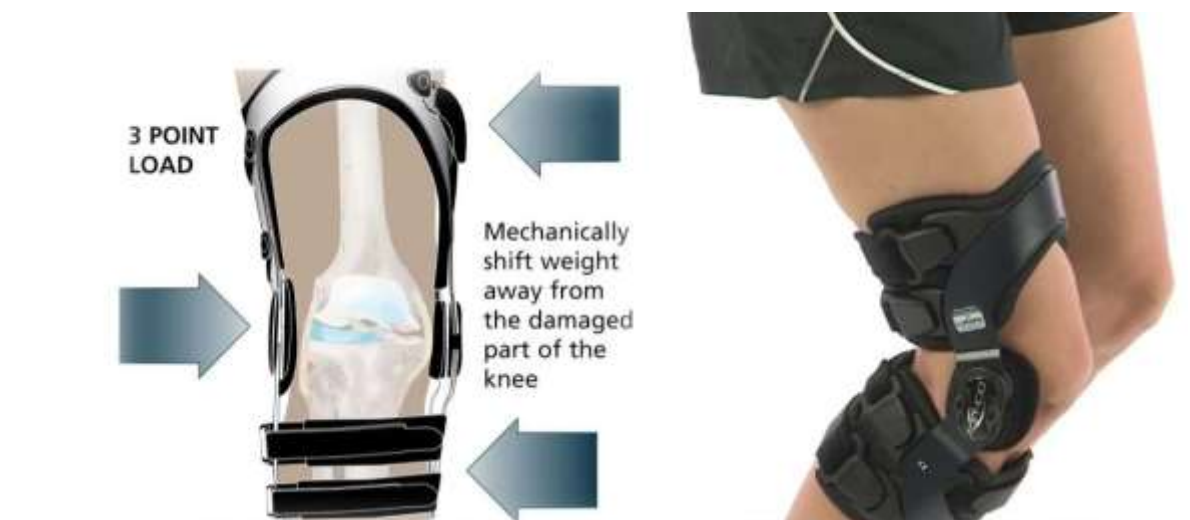
Figura 45.- Representación del principio de funcionamiento para la generación de fuerza compensación [69].
