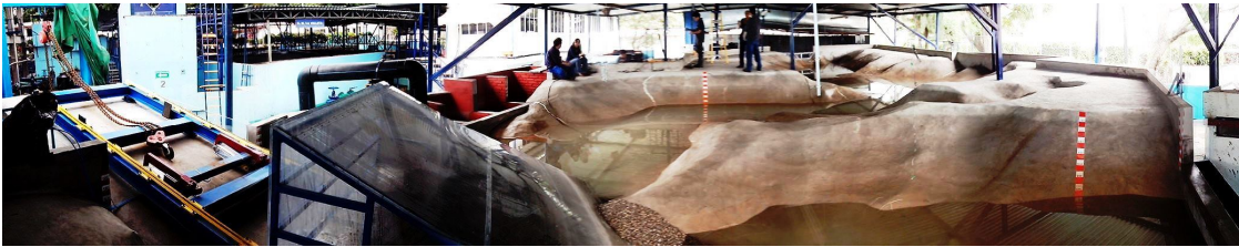
Fig 2.7. Modelo físico del embalse la Yesca Fuente: Gómez et al. (2016)
