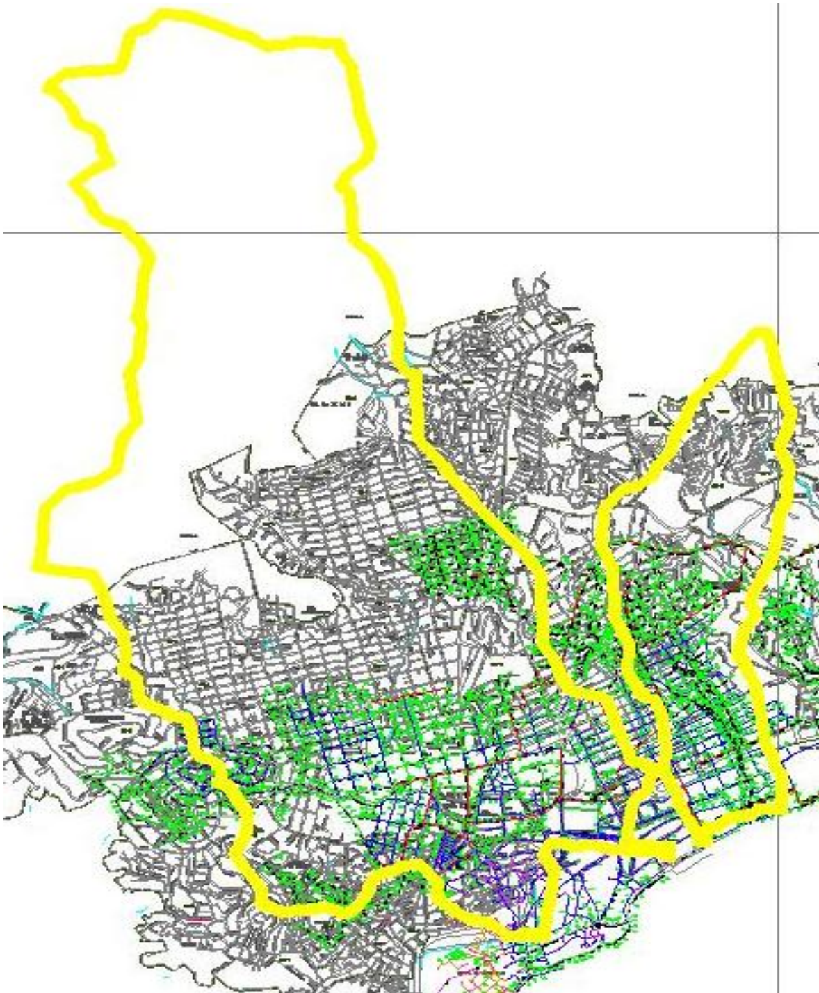
Figura 5.2. Trazo general de la red de alcantarillado en las cuencas de los Ríos Camarón (Este) y Arroyo Aguas Blancas (Oeste), Municipio de Acapulco, Guerrero. El contorno amarillo delimita las dos áreas de estudio, las acotaciones de color verde indican la elevación de la tubería del alcantarillado municipal, en
