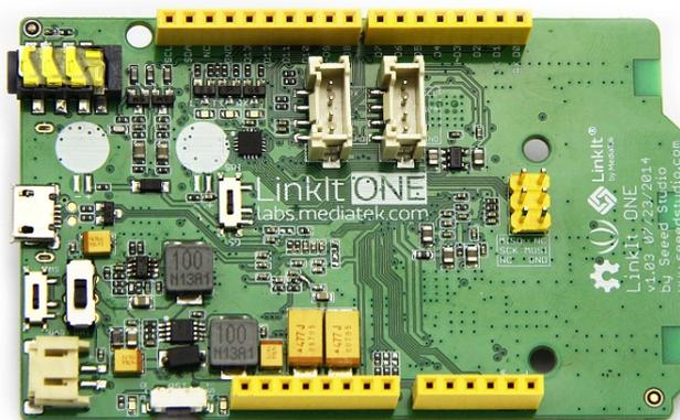
Figura 5.8: Tarjeta de adquisición de datos Linkit One MR.
