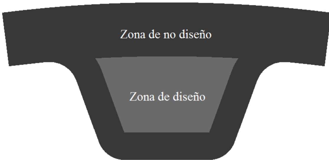
Figura 3.15. La zona de color más tenue representa la zona de diseño para optimización topológica en el diente L.
