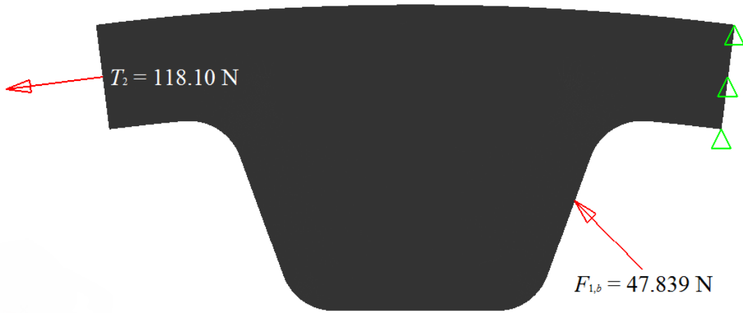
Figura 3.6. (a) Cargas aplicadas en el diente XXH cuando \psi = 45.7521^\circ .
