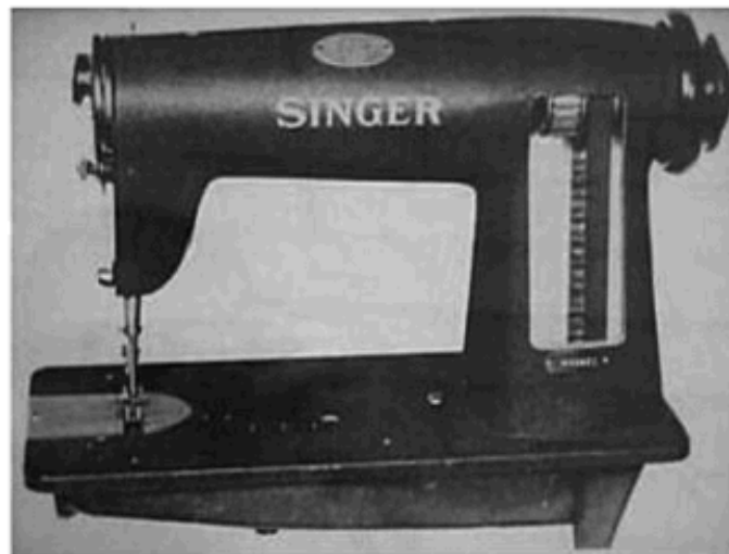
Figura 1.1. Primera aplicación de las bandas temporizadoras en las máquinas de coser Singer [5].
