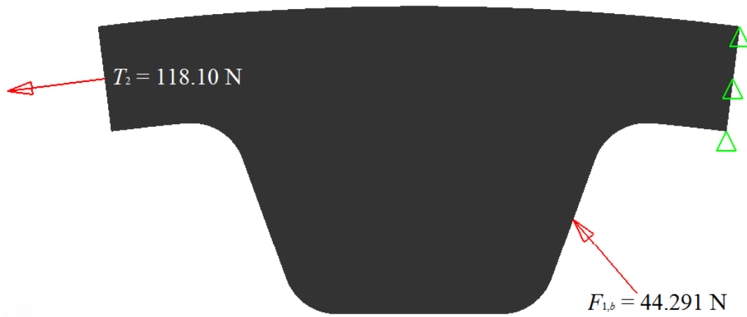
Figura 3.6. (b) Cargas aplicadas en el diente XXH cuando \psi = 49.4973^\circ .
