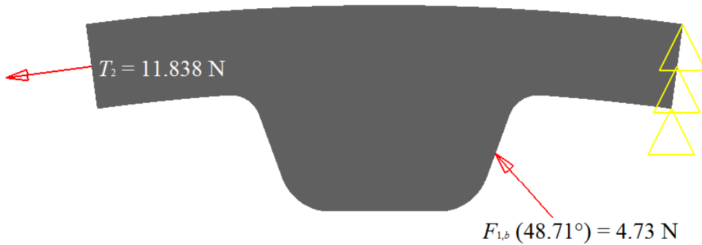
Figura 3.5. (c) Cargas aplicadas en el diente L cuando \psi = 48.71^\circ .
