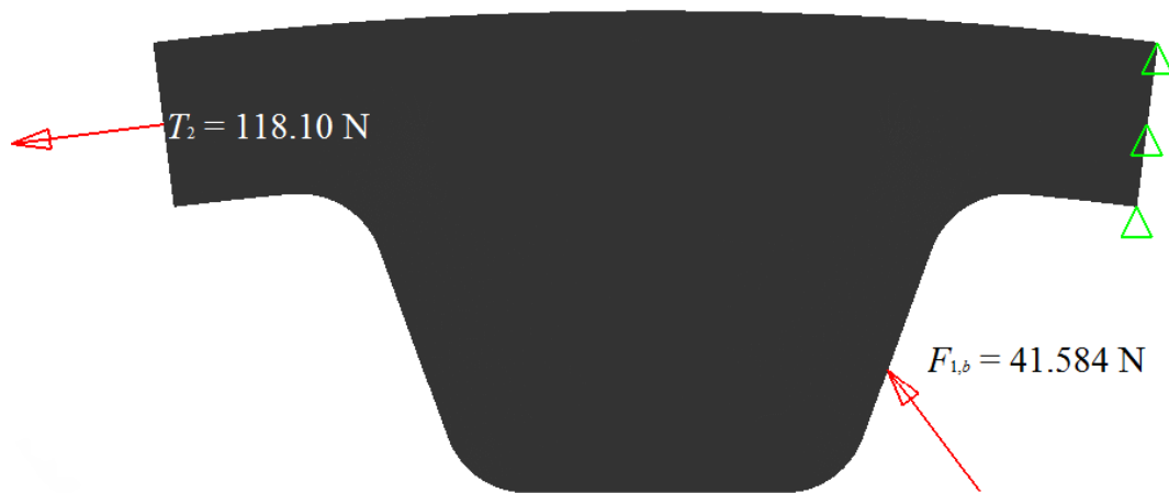
Figura 3.6. (c) Cargas aplicadas en el diente XXH cuando \psi = 52.9781^\circ .
