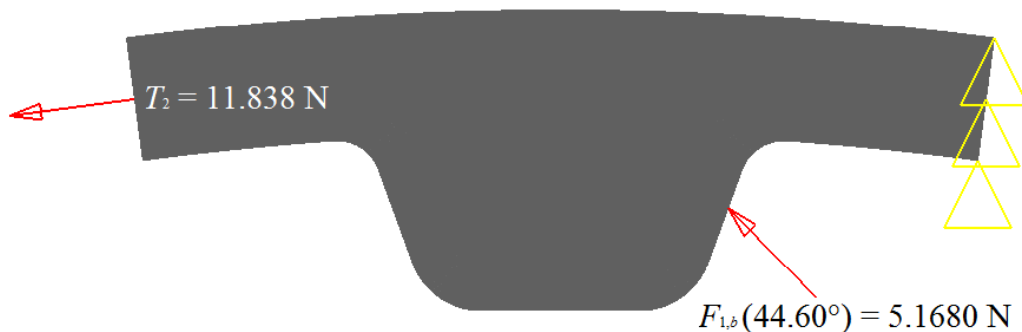
Figura 3.5. (a) Cargas aplicadas en el diente L cuando \psi = 44.60^\circ .
