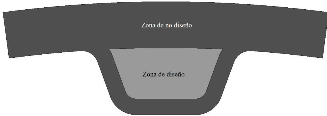
Figura 3.15. La zona de color más tenue representa la zona de diseño para optimización topológica en el diente L.
