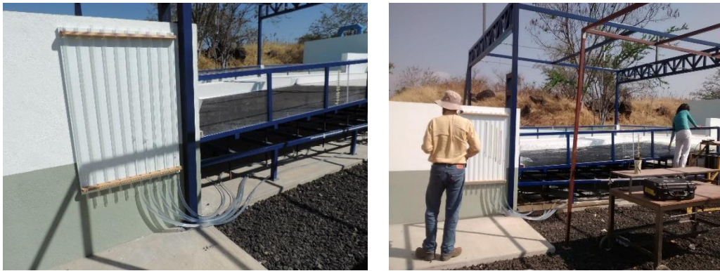
Figura 4-99 Piezómetros y empleo para la medición de tirantes simultáneos
