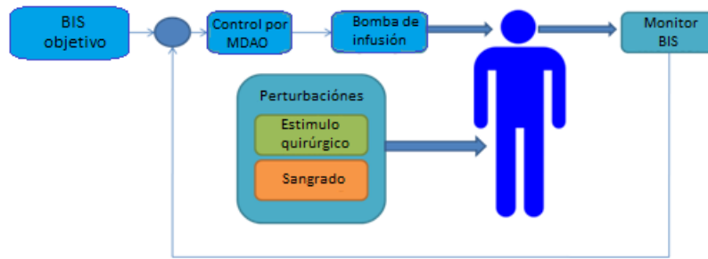
Figura 1.21: Diagrama de infusión de propofol de lazo cerrado
