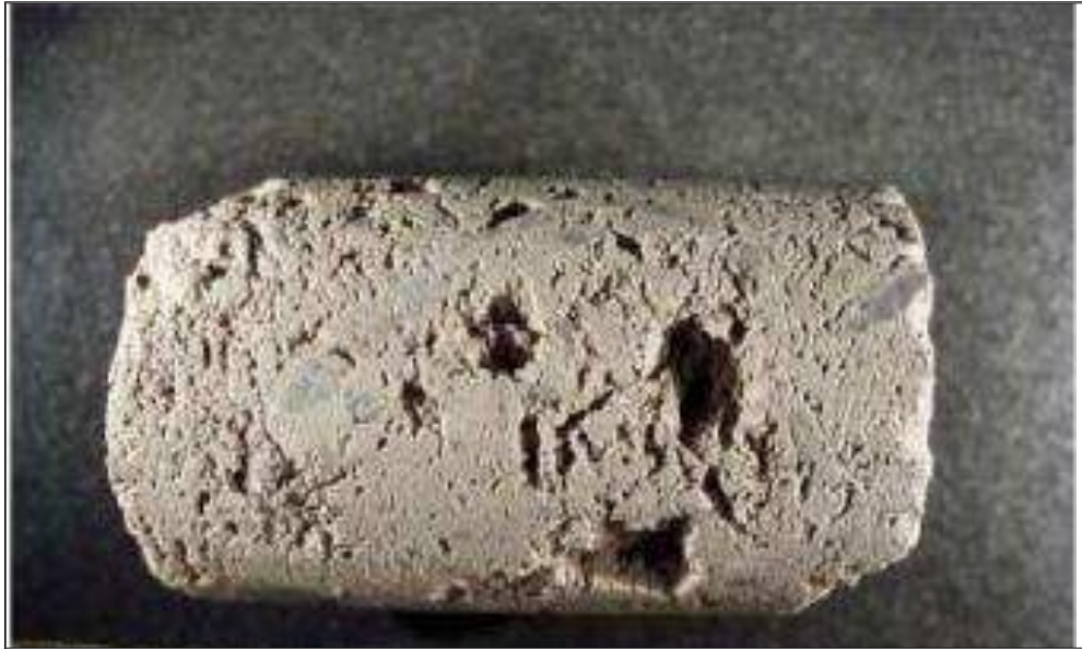
Fig.4 Núcleo de la brecha paleoceno, donde se observa la porosidad, cavidades de disolución y fracturamiento.
