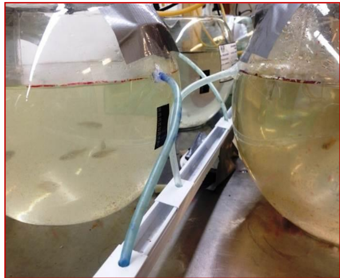
Figura 16. Tirante de pecera: 5L, nivel de salida de agua constante
