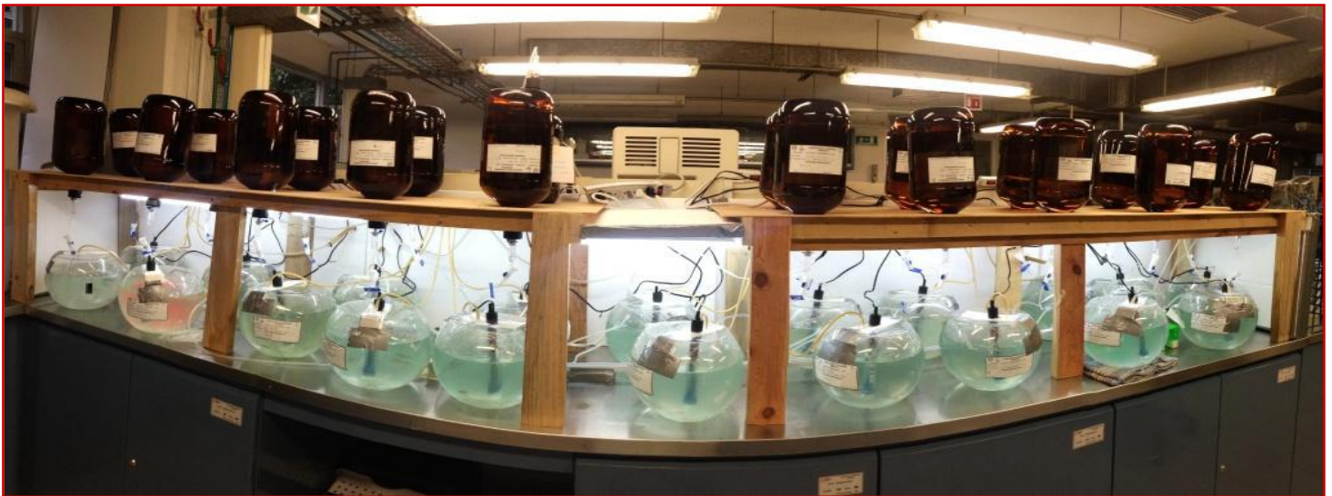
Figura 17. Montaje completo para Sistema experimental – ecotoxicidad con modelo Danio rerio
