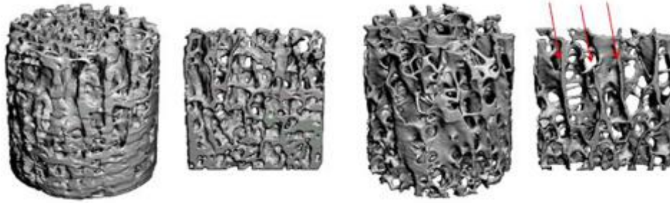
Figura 11: Aplicación de Micro-CT reconstruir hueso poroso humano [31].
