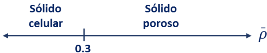
Figura 2: Esquema de diferencia entre un sólido celular y un material poroso [2].
