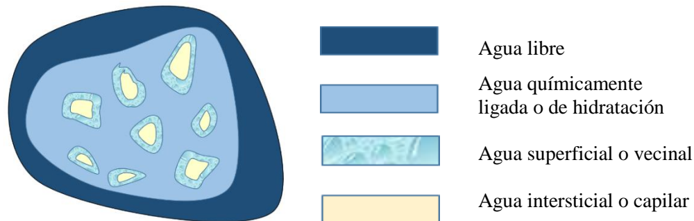
Figura 1.4 Distribución del agua en un floc de lodo generado en el tratamiento de agua. Fuente: (Perrazo & del Pilar, 2012)
