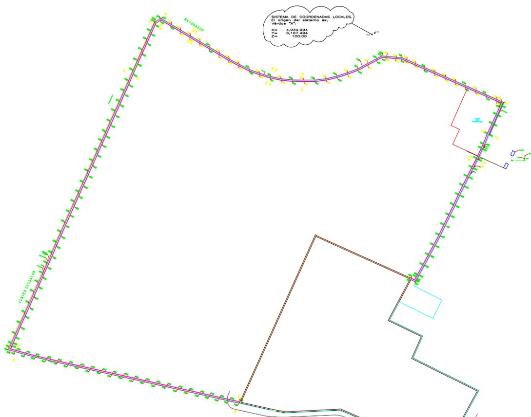
Ilustración 22. Planta con distribución de paneles de muro Milán del proyecto Mítikah fase II.
