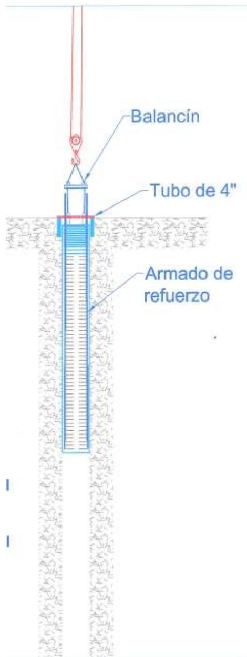
Ilustración 92. Colocación armado de acero.
