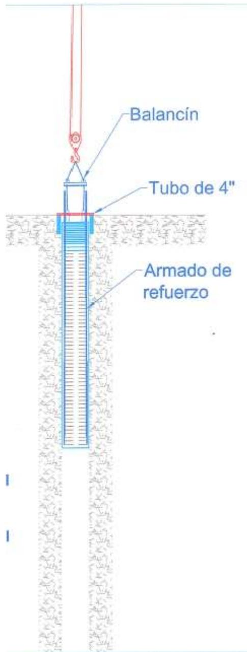
Ilustración 77. Colocación orejas para bajar armado a nivel de pilas de cimentación.
