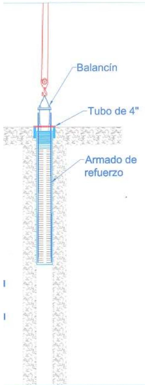
Ilustración 76. Colocación armado de acero.
