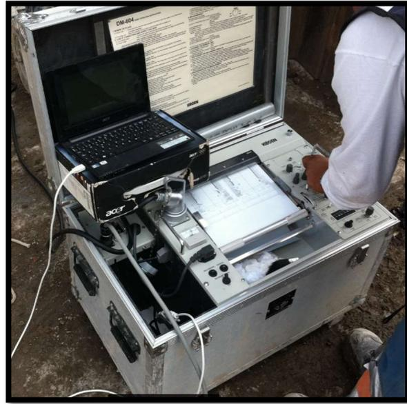
Ilustración 36. Kodon en pila perforada
