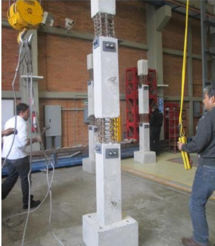
Figura 4.2. Conexión columna- columna (Escobar et al., 2015)
