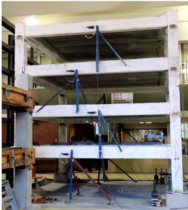
Figura 4.4. Modelo del edificio prefabricado de concreto reforzado (Escobar et al., 2015)
