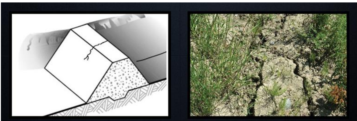
Figura 1.13 Falla por agrietamiento transversal. U.S. Department of Agriculture (2012).
