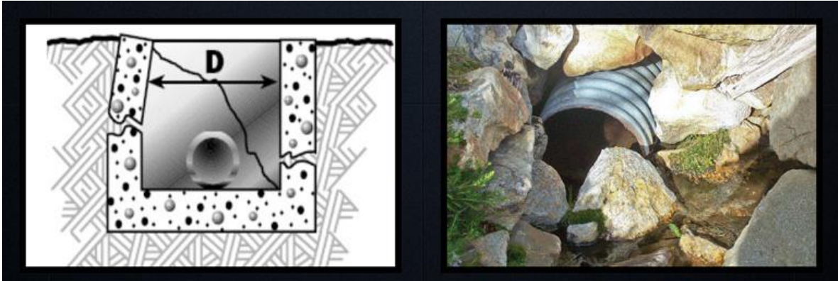
Figura 1.20 Falla por fractura en estructura de concreto o mampostería. U.S. Department of Agriculture (2012).
