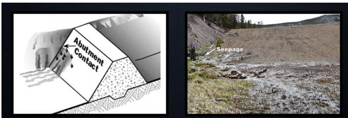
Figura 1.18 Falla por filtración en la ladera de la presa. U.S. Department of Agriculture (2012).
