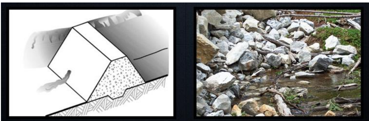
Figura 1.16 Falla por erosión interna. U.S. Department of Agriculture (2012).
