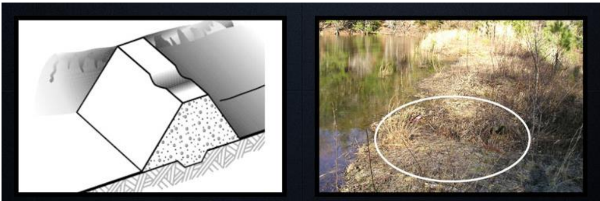
Figura 1.15 Falla por depresión en la corona. U.S. Department of Agriculture (2012).
