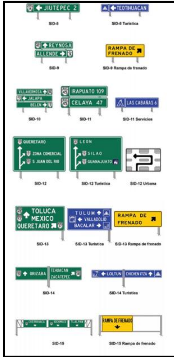
Figura 2.18 Catálogo de Señales Informativas de Destino (SID). Fuente: Manual de Señalización Vial y Dispositivos de Seguridad 2014.
