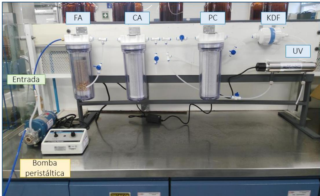
FIGURA 13 PLANTA PILOTO PARA LA POTABILIZACIÓN DEL AGUA DE LLUVIA CAPTADA EN LA AMC
