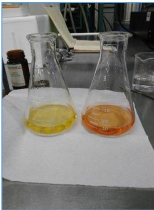
IMAGEN 7 DETERMINACIÓN DE LA ALCALINIDAD
