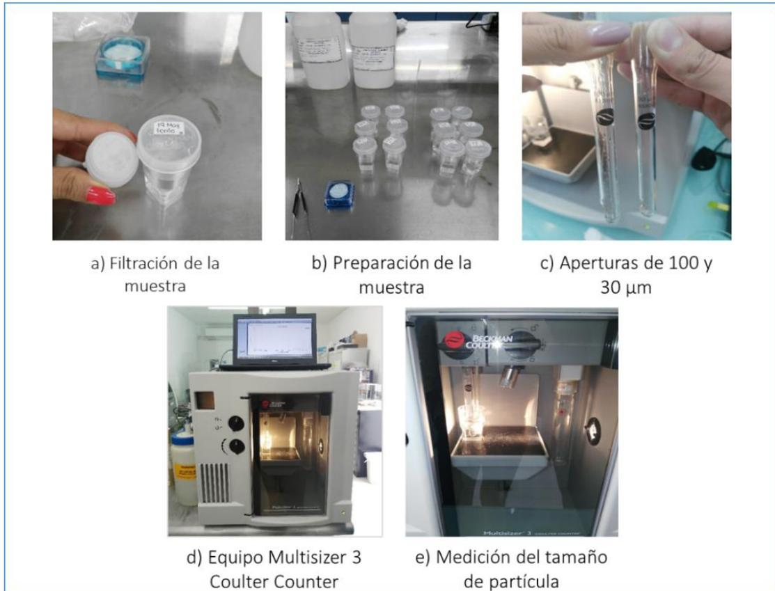
FIGURA 9 PROCEDIMIENTO PARA LA MEDICIÓN DEL TAMAÑO DE PARTÍCULA
