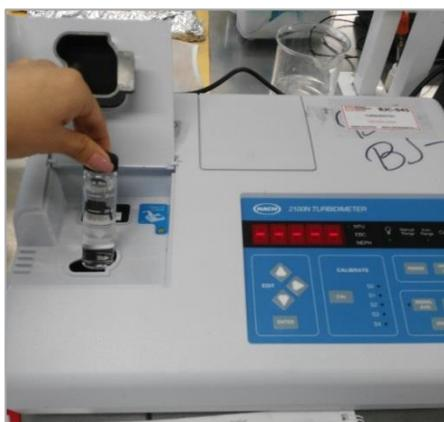
FIGURA 7 TURBIDÍMETRO HACH
