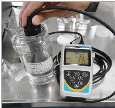
FIGURA 6 POTENCIÓMETRO UTILIZADO PARA LA MEDICIÓN DEL PH
