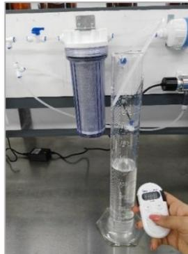
FIGURA 14 MEDICIÓN DEL GASTO DE LA BARRERA KDF
