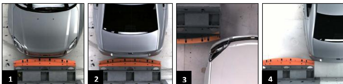
Figura 2.6 – Prueba de parachoques a baja velocidad. 1) Parachoques delantero completo. 2) Parachoques trasero completo. 3) Esquina de parachoques delantero. 4) Esquina de parachoques trasero.
