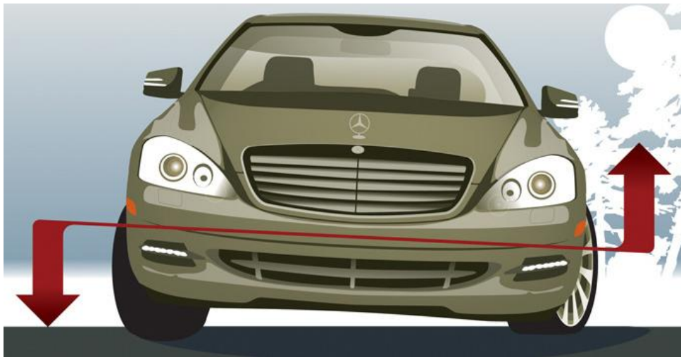
Figura 1.6 – Sistema de suspensión ABC (Active Body Control) de Mercedes Benz, diseñada para contrarrestar los efectos de balanceo y vibraciones, durante maniobras repentinas.
