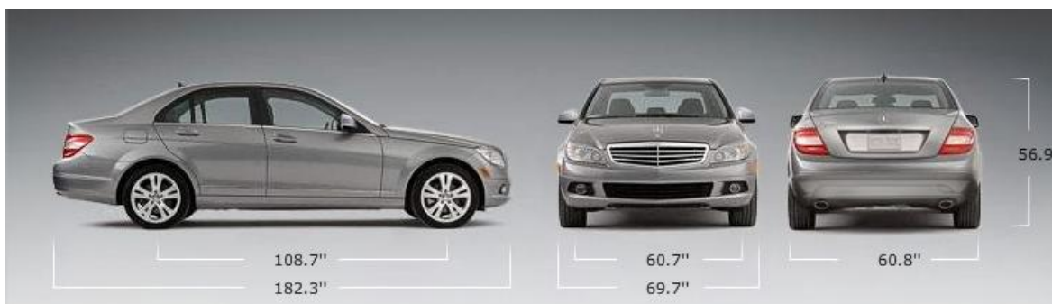
Imagen 5.1 – Automóvil tipo sedán de cuatro puertas. En esta imagen se muestran sus principales vistas con acotaciones en pulgadas.
