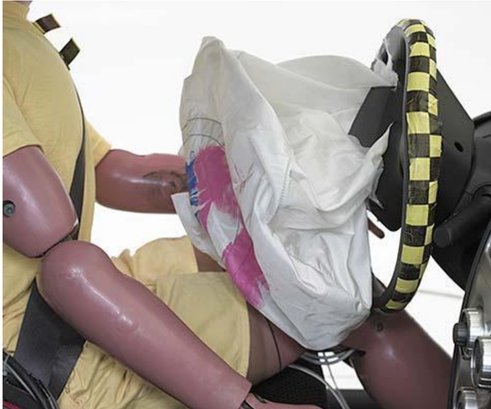
Figura A.13 – El volante doblado es evidencia de un fuerte golpe en la cabeza del maniquí a través de la bolsa de aire durante el impacto.
