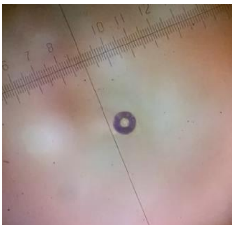
Figura 4.27 Vista del corte realizado a fibra HC-800B en microscopio.
