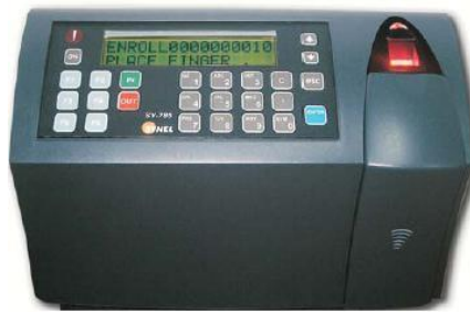
Figura 2.7 Controlador de acceso por combinación con enlace a computadora
