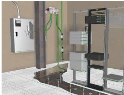
Figura 41 Sistema medular de puesta a tierra para telecomunicaciones, TBB 26
