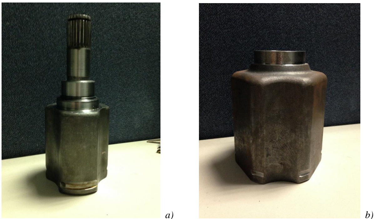
Figura. 4.2 Se aprecian los distintos tipos de cabeza GI (a) y AAR (b).
