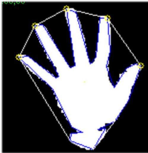
Fig. 30. Figura de identificación de los dedos basada en las operaciones de detección de bordes y ConvexHull. [24]
