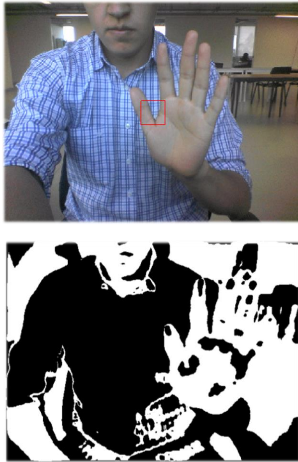
Fig. 25. En la parte superior, la imagen sin ningún tipo de procesamiento. En la parte inferior el resultado de la imagen después de toda la etapa de calibración y aplicación del filtro.
