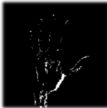
Fig. 19. Imagen resultado de reducir la tolerancia, en ésta, la forma de la mano se pierde casi por completo resaltando solo un pequeño número de pixeles.
