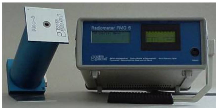
Figura 1.7. Pirheliómetro de cavidad absoluta, serie PMO-6.
