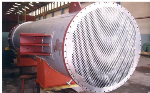
Fig. 2.15 Espejo de tubos de un intercambiador de tubo y coraza.
