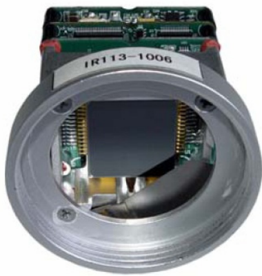
Figura 3.7 Módulo infrarrojo IR 112 GUIDIR con acoplamiento para el lente infrarrojo
