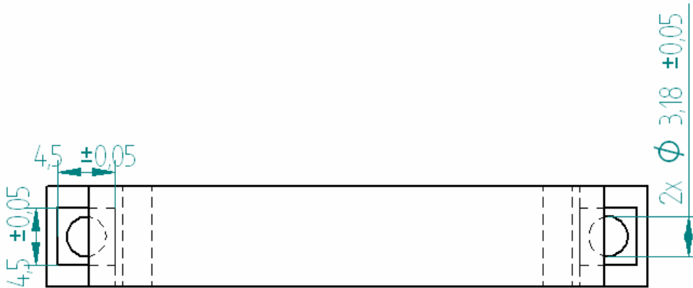
Figura 4.2.24 Dibujo dimensionado frontal de la sujeción del motor 1
