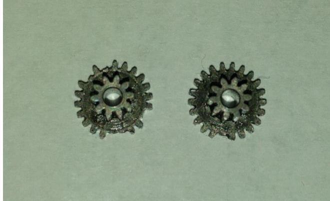
Ilustración 71 fotografía de engranes dañados
