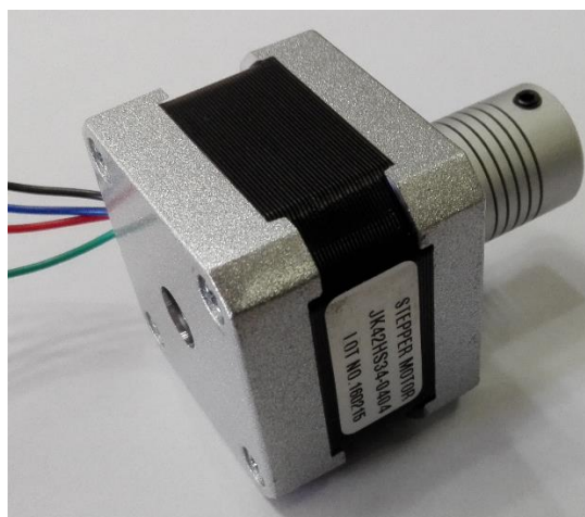
Figura 2.12 Motor a pasos usado en el segundo prototipo del Tomógrafo.
