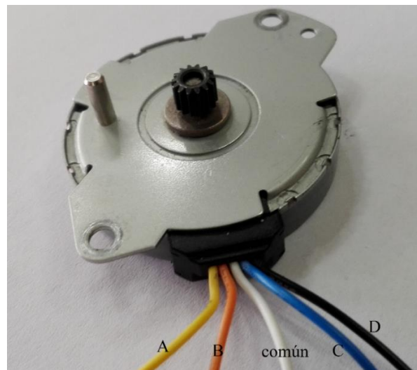
Figura 2.11 Motor a pasos usado en el primer prototipo del Tomógrafo.
