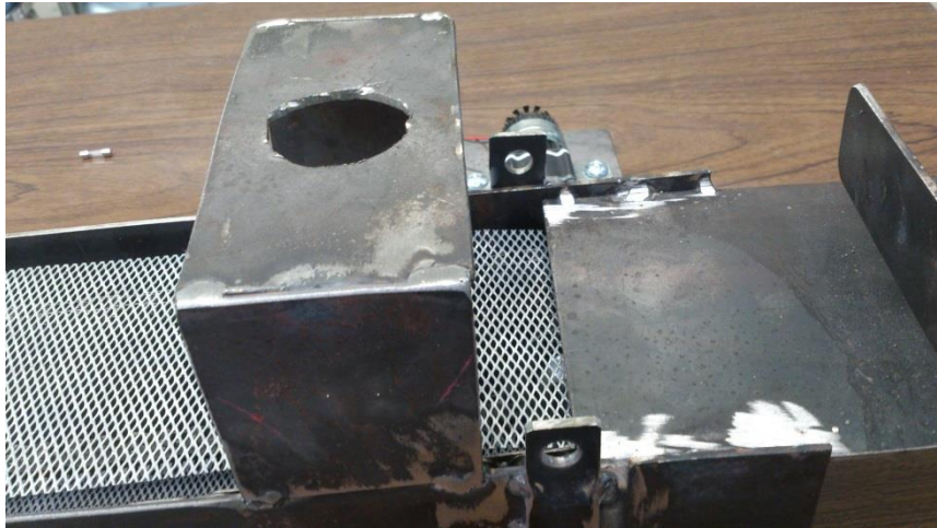
Imagen 30. Soportes del sensor capacitivo (izquierda) y sensores fotoeléctricos (derecha)
