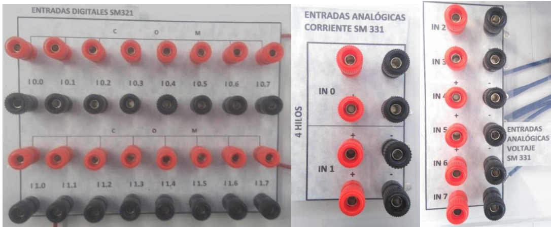
Imagen 40. Entradas analógicas y discretas del PLC S7-300
