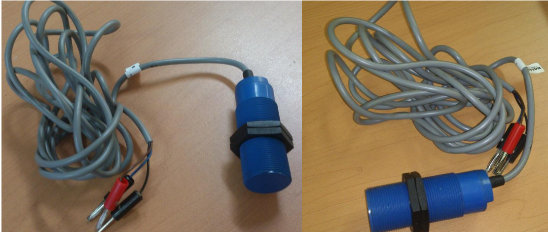
Imagen 6. Sensor capacitivo BCAW 030-NB-1-Y 03
