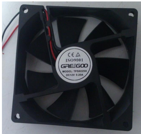
Imagen 8. Ventilador TFB9225H de 12 VDC
