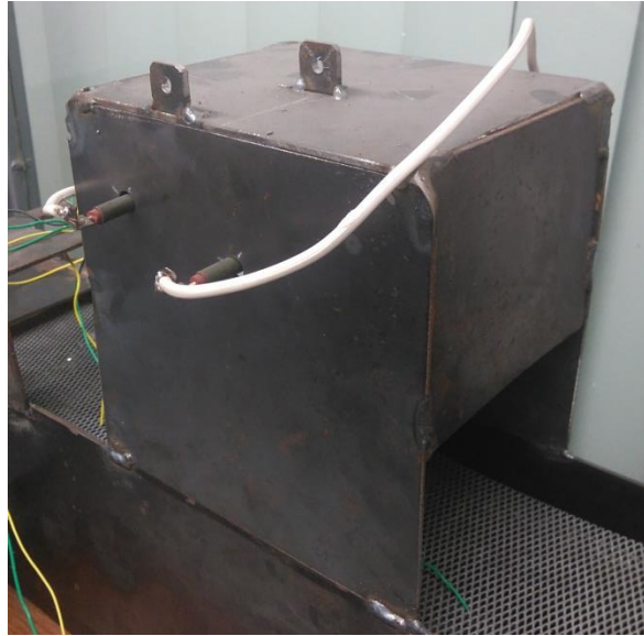
Imagen 32. Horno con resistencias montadas
