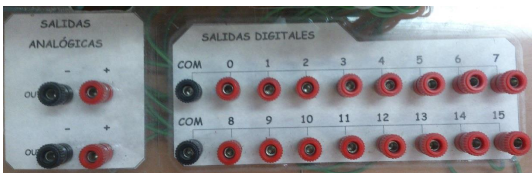
Imagen 38. Salidas analógicas y digitales del PLC SLC500
