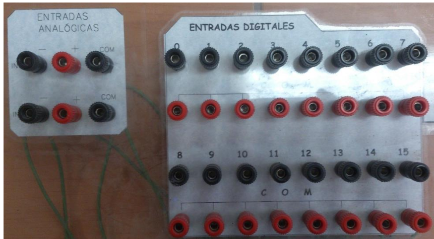
Imagen 37. Entradas analógicas y discretas del PLC SLC500
