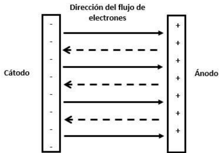
Figura 2. Flujo de electrones cátodo – ánodo y campo interno 5 .
