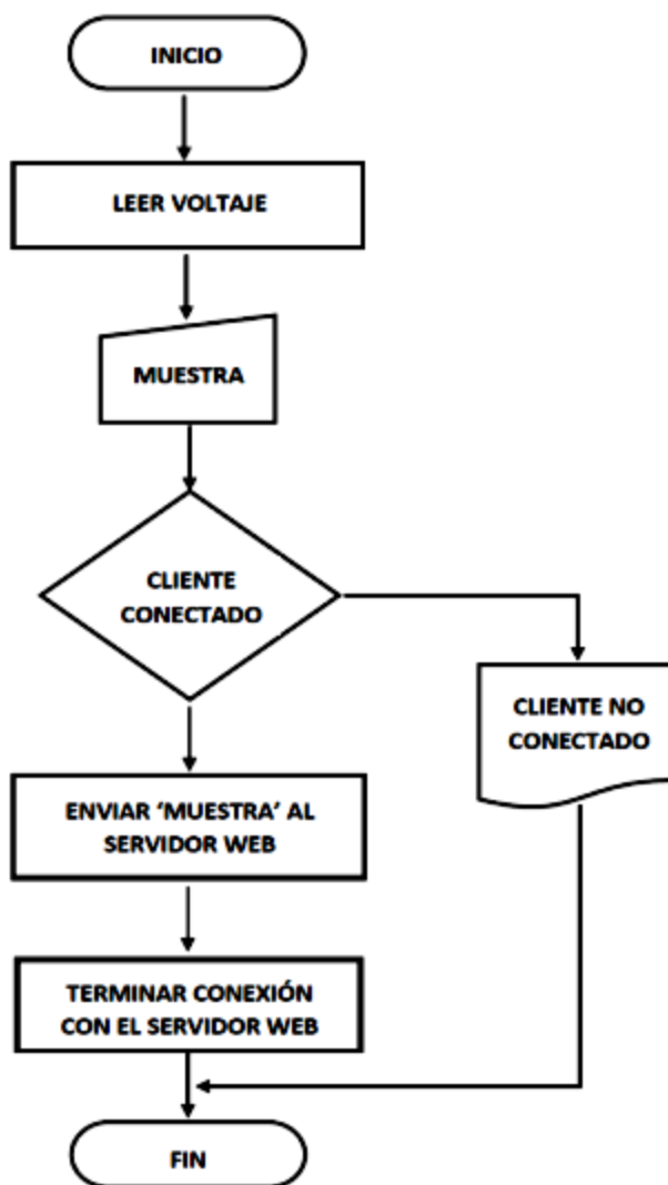
Figura 36. Programa en Arduino para leer voltajes y enviarlos al servidor 110 .
