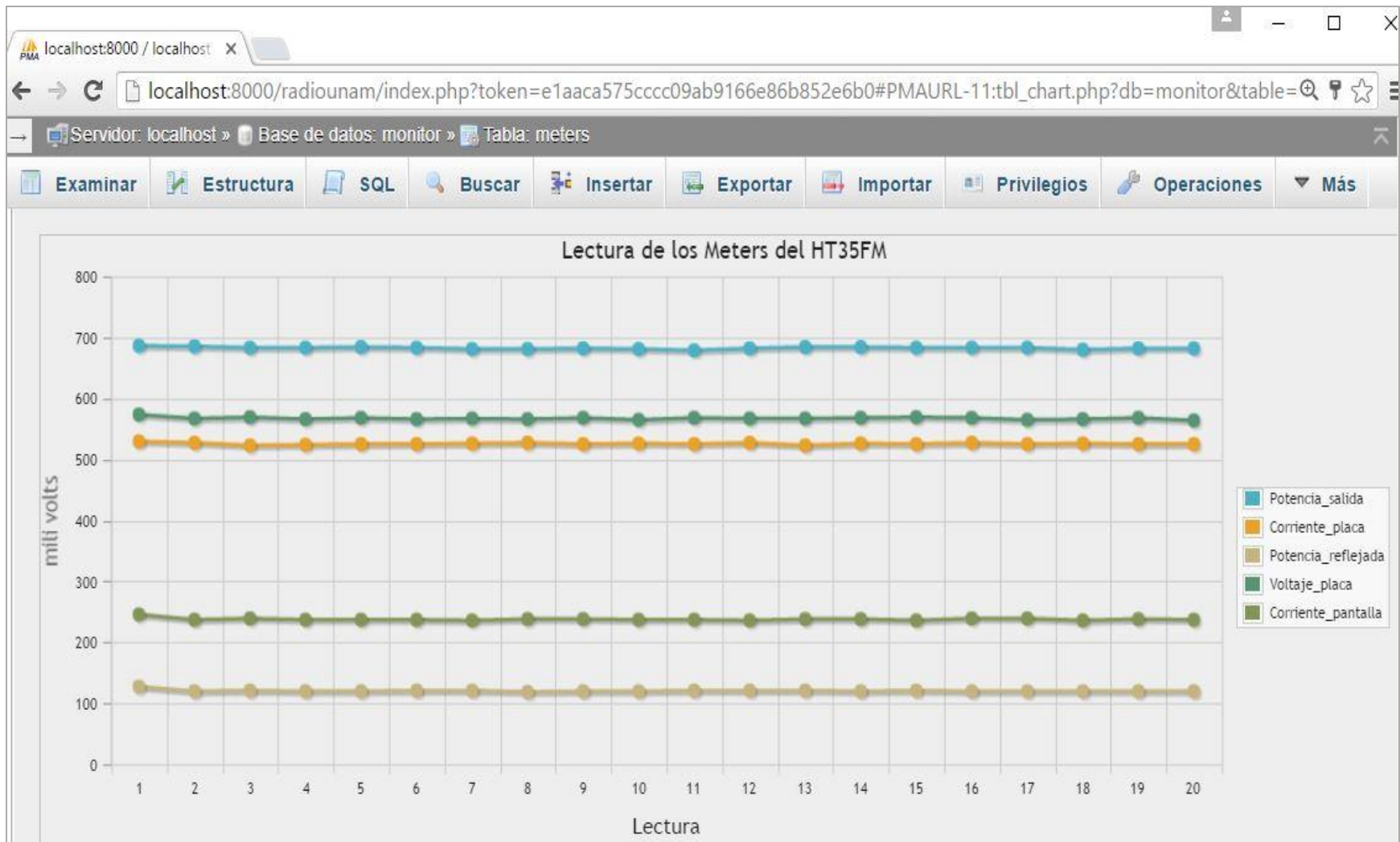
Figura 53. Gráfica de las lecturas del voltaje en los Meters del HT35FM.
