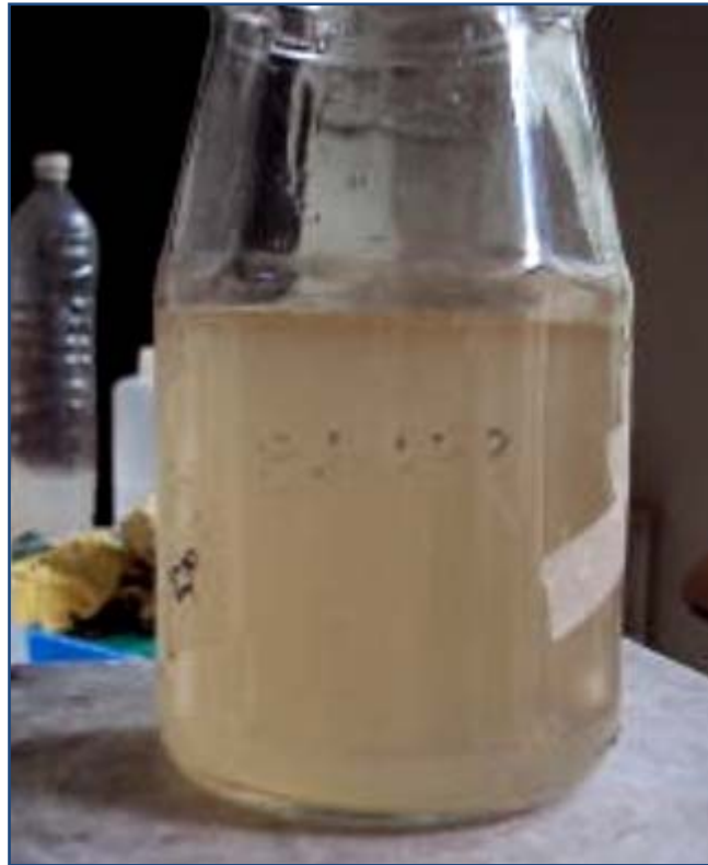
Figura No. 1. Prueba de jarras con adición de policloruro de aluminio. Fuente del autor.
