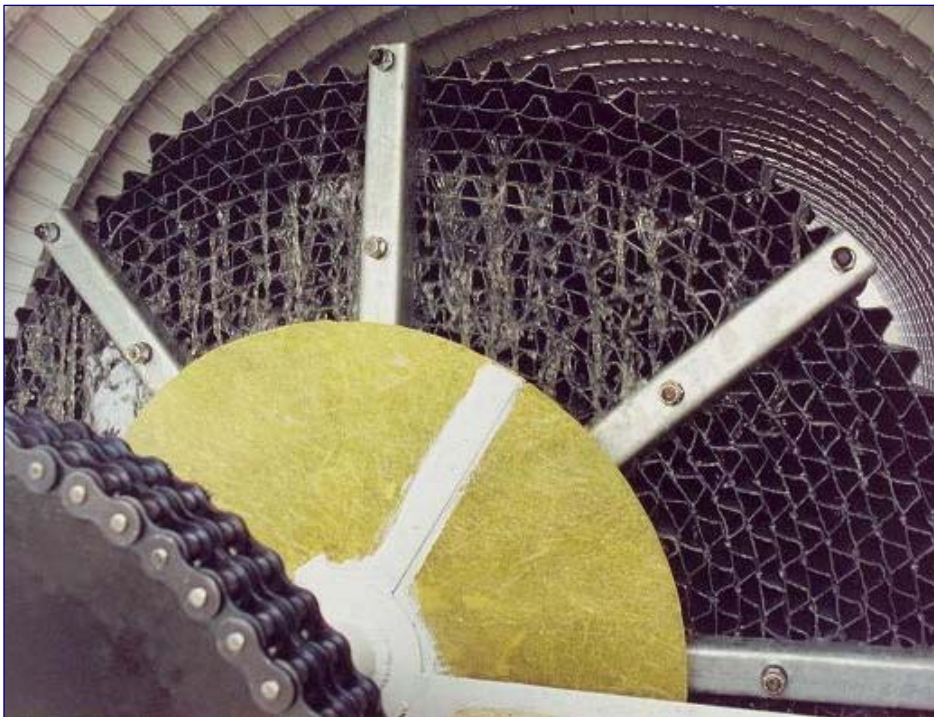
Figura No. 11. Observación de la distribución del flujo en el medio corrugado. Fuente del autor.
