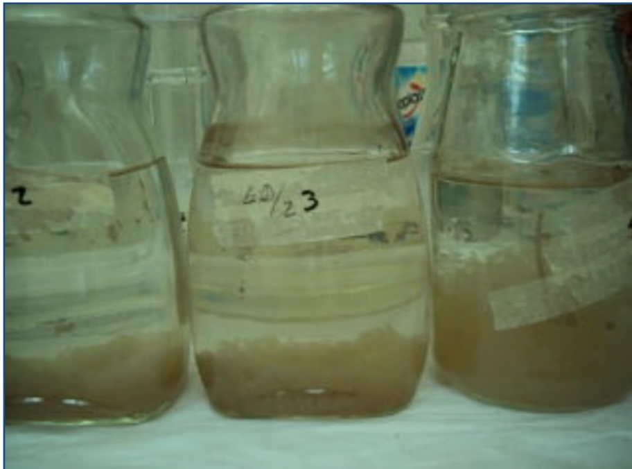
Figura No. 3. Prueba de jarras con floculo sedimentado. Fuente del autor.
