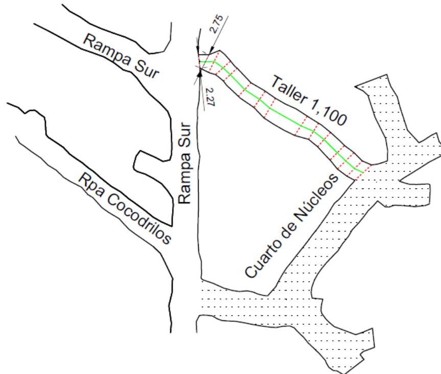
Figura 6.5 Anchos críticos del Taller 1,100
