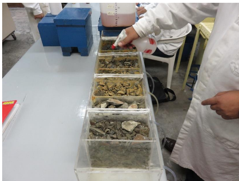
Figura 5.11 Limpieza con atomizador
