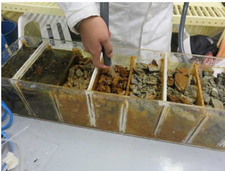
Figura 5.12 Limpieza con manguera y agua a presión
