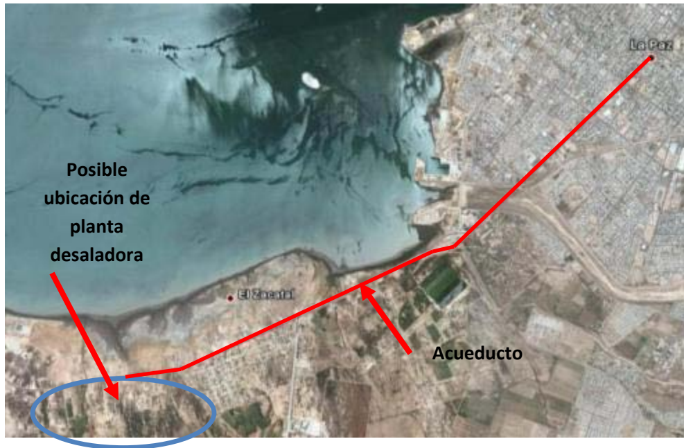
Figura 11: Acueducto de impulsión del agua producto
