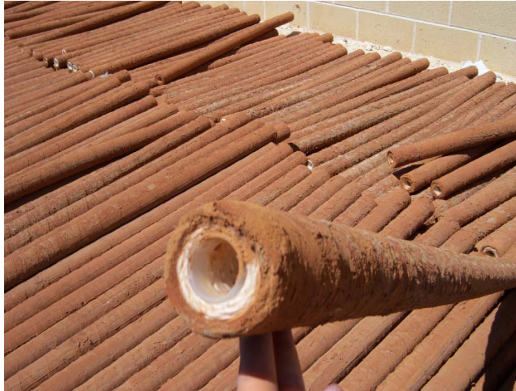
Figura 11: Daño a filtros cartucho debido a la falta del filtro arena en el pretratamiento
