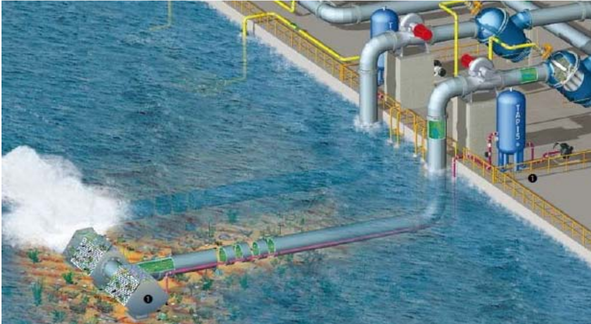
Figura 5: Obra de toma abierta, cortesía IDA Desalination Yearbook 08-09
