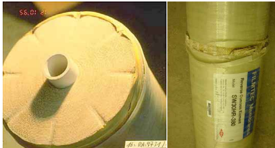
Figura 3: Daño en membranas debido a un exceso de presión en la alimentación del sistema de desalación
