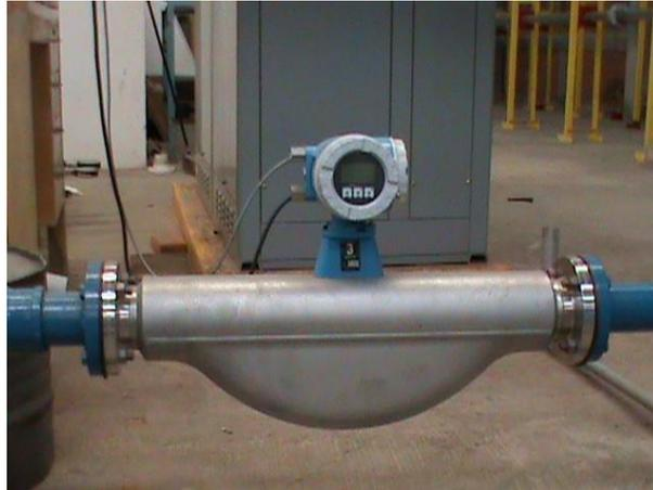
Figura 3.4: sensor de coriolis usado en la tubería
