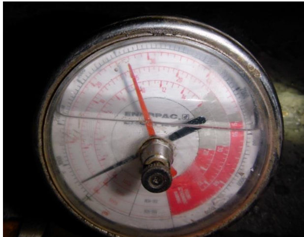
46:Figura No. VIII. 13. Manómetro, indicando tonelaje aplicado
