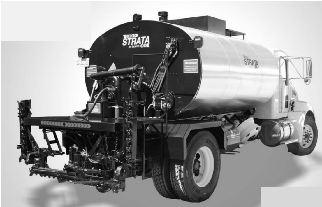
Figura 76. Petrolizadora Strata–Seaman de 8,000 l.
