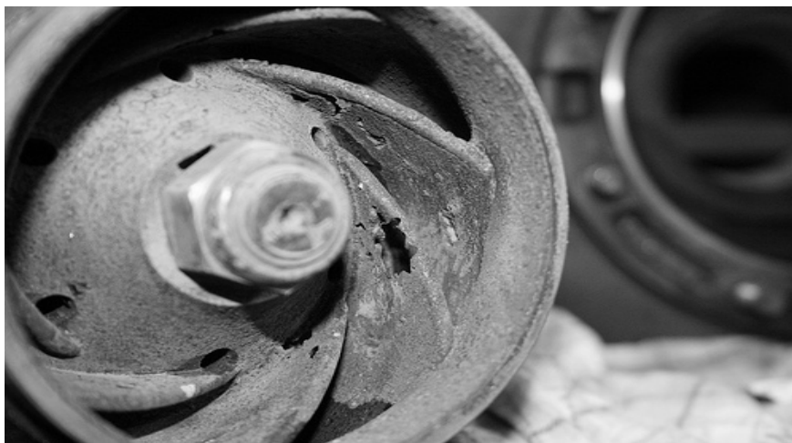
Fuente: Cavitación en las bombas de agua-Peligro de su inmersión.
