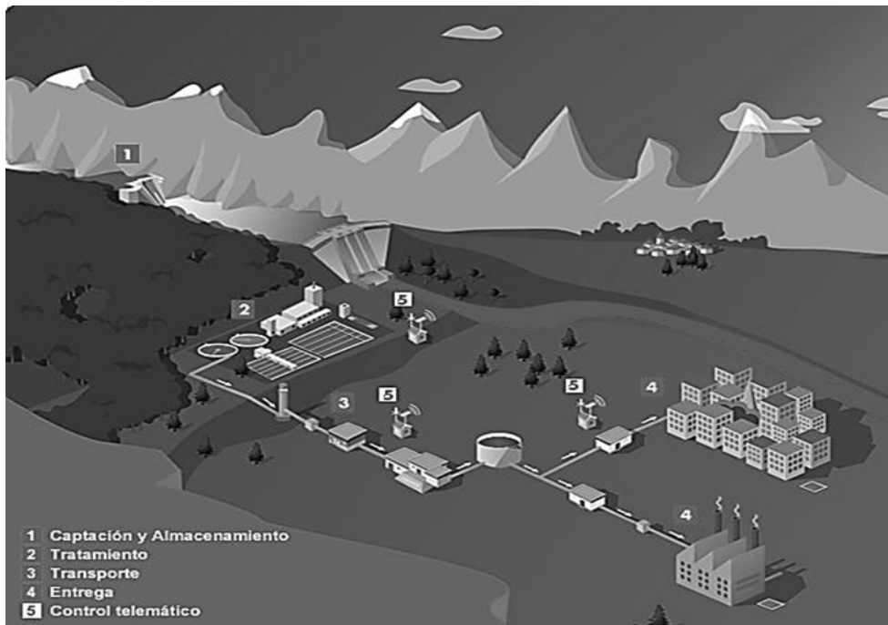
Figura 2. Esquema general de sistema de bombeo para abastecer agua potable a la sociedad.
