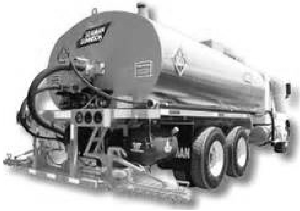
Figura 75. Petrolizadora Seaman de 6,000 l.
