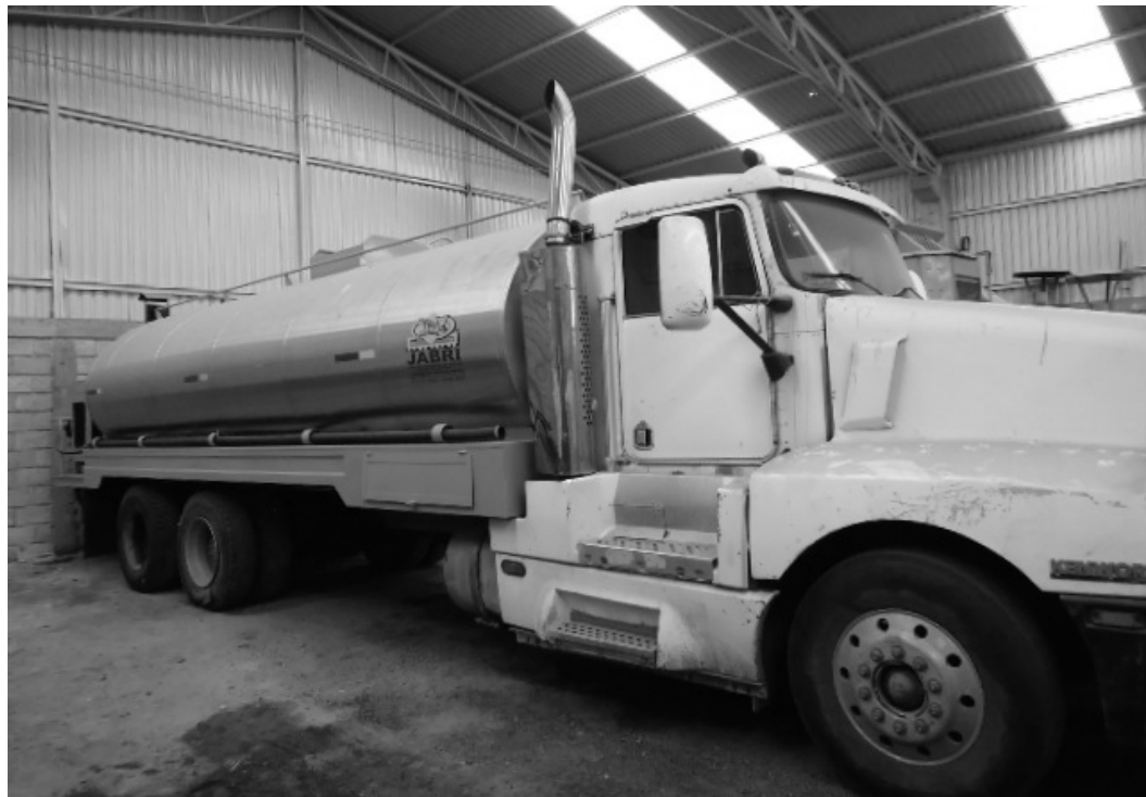
Figura 79. Petrolizadora Jabrí de 18,000 l.
