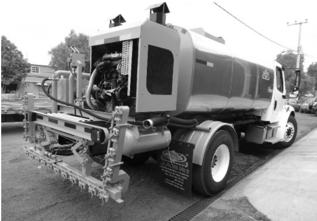
Figura 78. Petrolizadora Jabrí de 6000 l.
