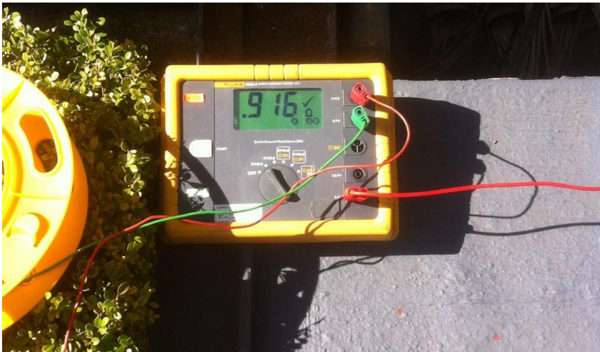
Figura 3.25 Imagen de terrómetro indicando 0.916 ohms (fuente: fotografía tomada por el autor).
