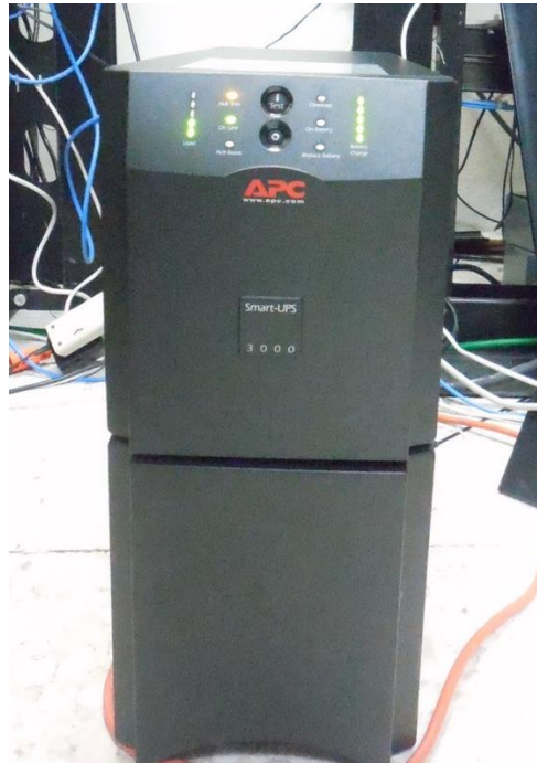
Figura 3.5 Fotografía de un UPS (fuente: fotografía tomada por el autor).
