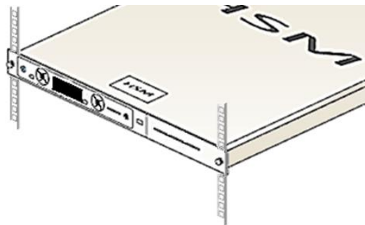
Fig. 15 Montaje en rack de un HSM
