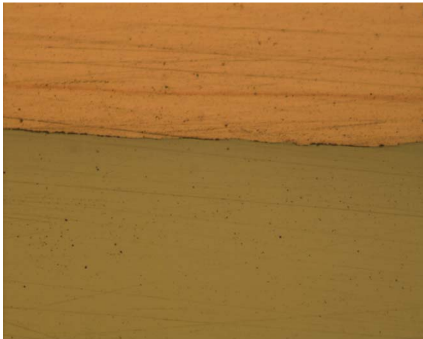
Fotografía 4. Material colaminado acero cobre con precalentamiento a 800°C, dos reducciones de espesor por laminado del 20% y recocido a 850°C durante 1 hora a 200 X.
