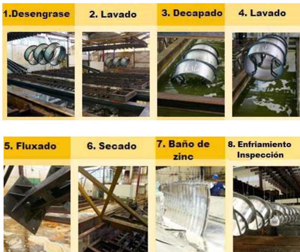
Figura 2.3. Proceso de galvanizado
