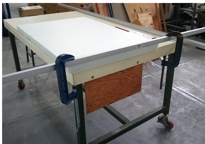
Fig. 3.26. Corte del aislante térmico.
