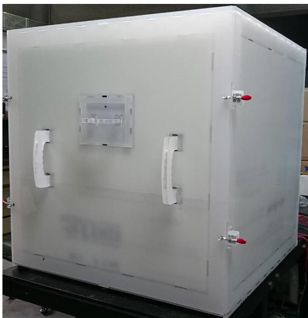
Fig. 3.7. Apariencia final de la cámara de temperatura
