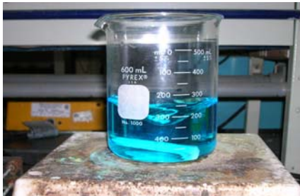
Paso No. 4: Preparación del sulfato de cobre.
