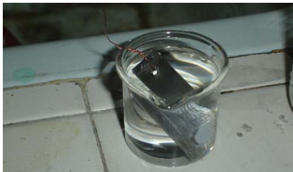
Paso No. 5: Limpieza de la pieza en acetona.
