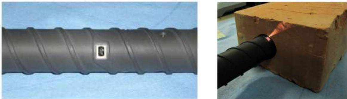
Figura 3.8 Las pruebas Ma-MISS con material como toba se han llevado a cabo para evaluar y caracterizar el desempeño del sistema. Las pruebas han demostrado que el instrumento es capaz de adquirir señales precisas reflejadas a partir de minerales representativos, tales como olivino y yeso. Créditos ESA, exploration.esa.int 2015.
