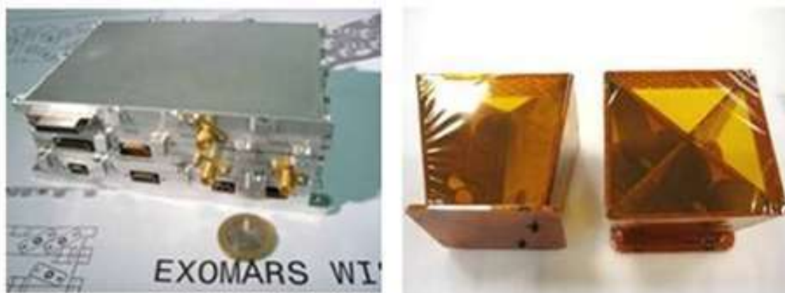
Figura 3.7 Unidad electrónica y antenas, WISDOM ExoMars. ESA. exploration.esa.int 2015.
