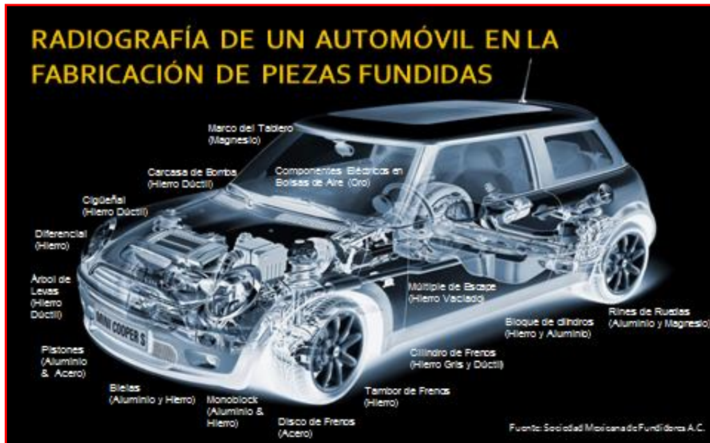
Figura 8 Posible ubicación de piezas fundidas con hierro dúctil en un automóvil. [2]
