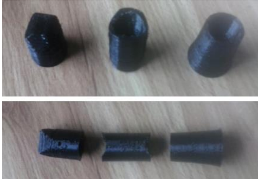
Imagen 5.2.- Falanges impresas en 3D. De izquierda a derecha, falange distal, media y proximal.
