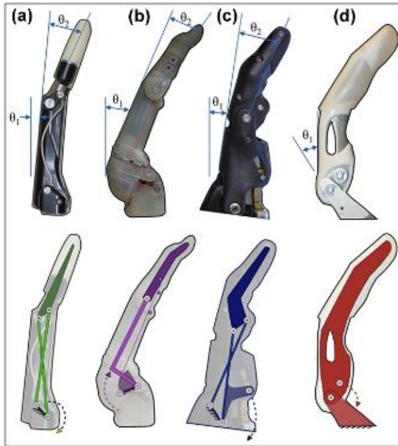
Imagen 1.22.- Imágenes de dedos comerciales (arriba) y mecanismo de sus articulaciones (abajo). (a) Vincent (Vincent Systems), (b) i-limb (Touch Bionics), (c) Bebionic (RSL Steeper), (d) Michelangelo (Otto Bock). [17]
