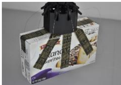
Imagen 1.10.- Gripper de electroadhesión adaptándose a la forma del objeto a sujetar. [42]
