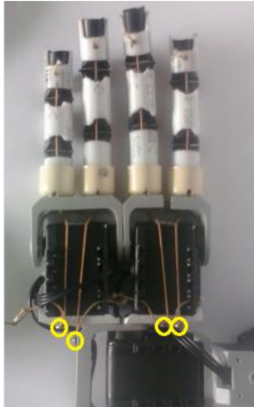
Imagen 3.18.- Sujeción de tendones en la base de la mano.
