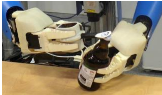
Imagen 1.13.- Interacción entre el gripper y el objeto a través de un elemento intermedio. [1]
